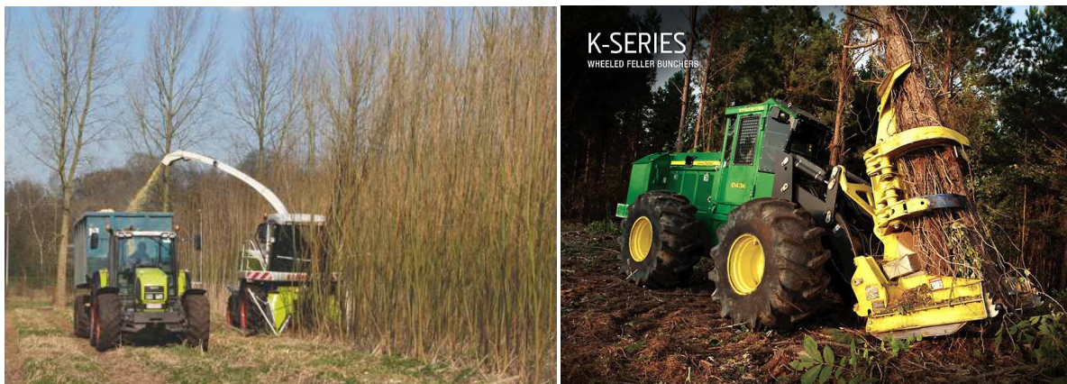
Abbildung 6-11: links: Vollmechanisierte Pappelernte - Hackgutlinie - in einer KUP mit Mini-Rotation (Quelle: Claas); rechts: Fäller-Bündler (Quelle: John Deere)
