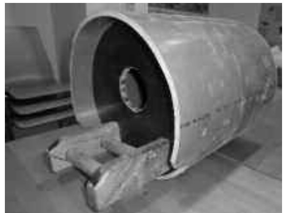
Dohlenkasten gefertigt aus einem Kanalrohr Foto: Günter Tillinger
